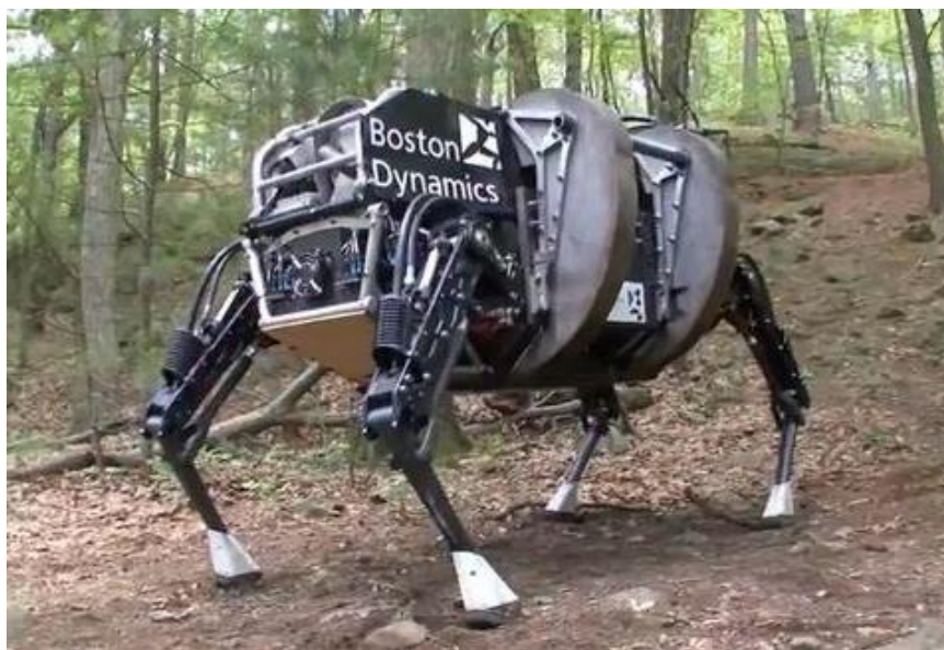
Рис.6 Военный робот поддержки военнослужащих Legged Squad Support System
