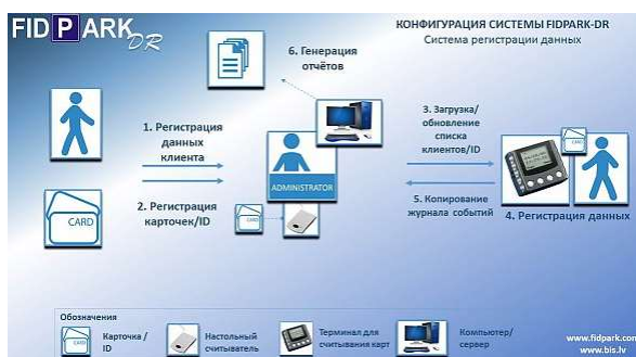
Рисунок 5. Система FidPark Data Registration (DR)
