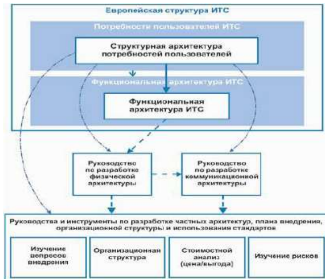
Рисунок 7 – Модель разработки локальных архитектур ИТС
