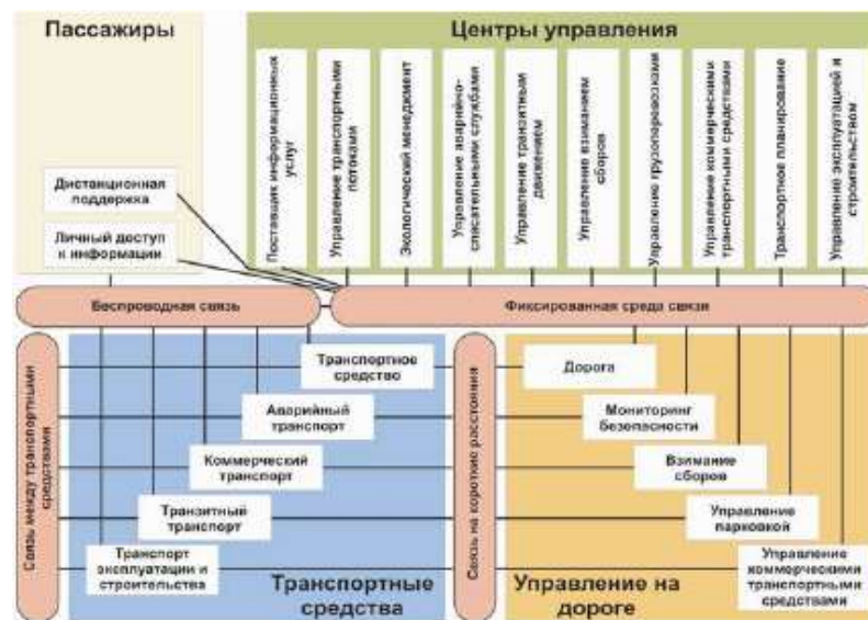
Рисунок 4 – Физическая архитектура ИТС США
