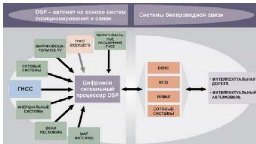
Рисунок 9 – Технологии, используемые для построения навигационных приложений ИТС
