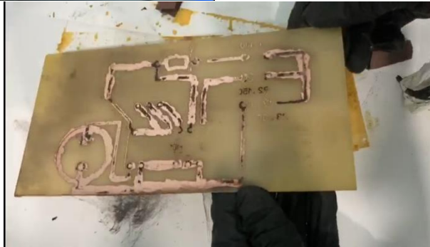
Сурет 13 – Баспа платасындағы схеманы құру жұмыс процесі
