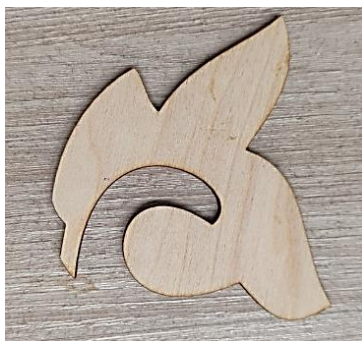
Рисунок 2 – Заготовка броши из фанеры, вырезанный на лазерном станке
