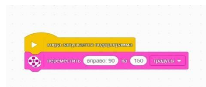
Рисунок 2 – пример поворота под углом 90^\circ на расстояние 150^\circ
