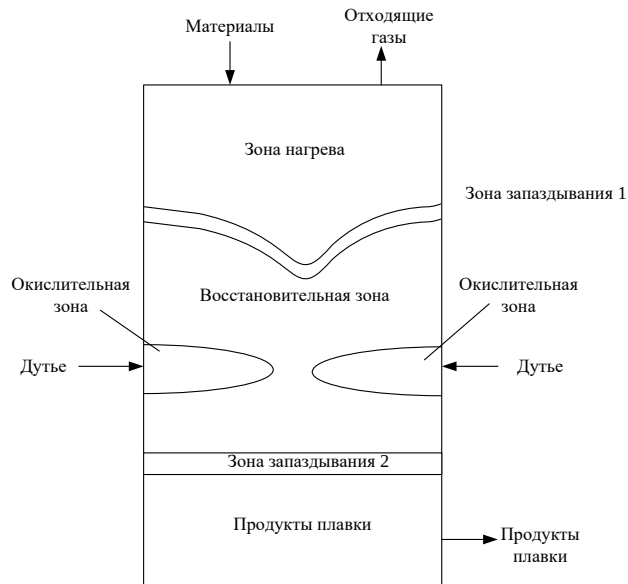
Рисунок 2 – Условное разбиение рабочего пространства шахтной печи на зоны
